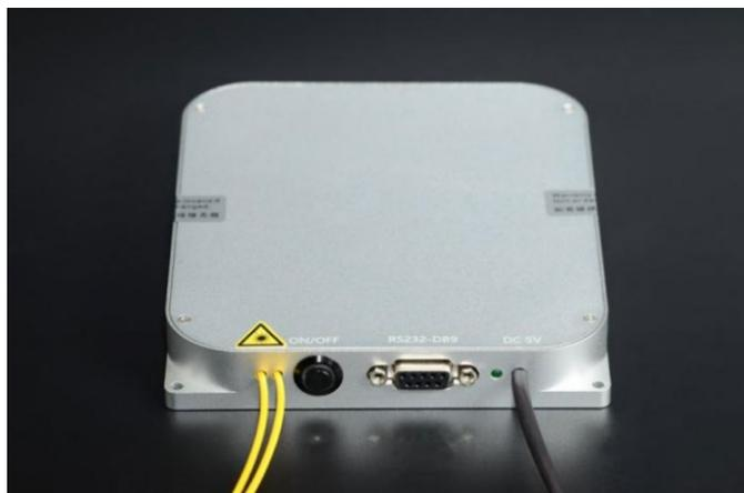
2. 该掺铒光纤放大器模块有一定的发热量, 放大器底部应与热沉或散热片紧密接触, 并配合充分的风冷散热, 以获得良好的散热效果。建议最佳工作环境温度为 $-5\sim+35^{\circ}\text{C}$ , 当环境温度超过 $50^{\circ}\text{C}$ 时, 待机状态下的放大器将无法启动; 当环境温度超过 $55^{\circ}\text{C}$ 时, 工作状态下的放大器, 会自动停止激光输出进入待机以自我保护, 当环境温度降低到 $50^{\circ}\text{C}$ 时, 放大器将自动恢复输出;
