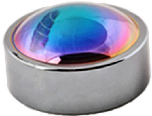
采用非球面透镜可以大大地减少光学系统中的透镜数量,尤其是在热成像系统中。传统的锗透镜或硒化锌透镜,由于每次只能加工一个,以及加工中的不稳定性导致一致性相对较低,从而耗费了大量的时间和财力。我们的红外模压非球面透镜,拥有高重复性和高一致性,保证了大规模的批量生产。
