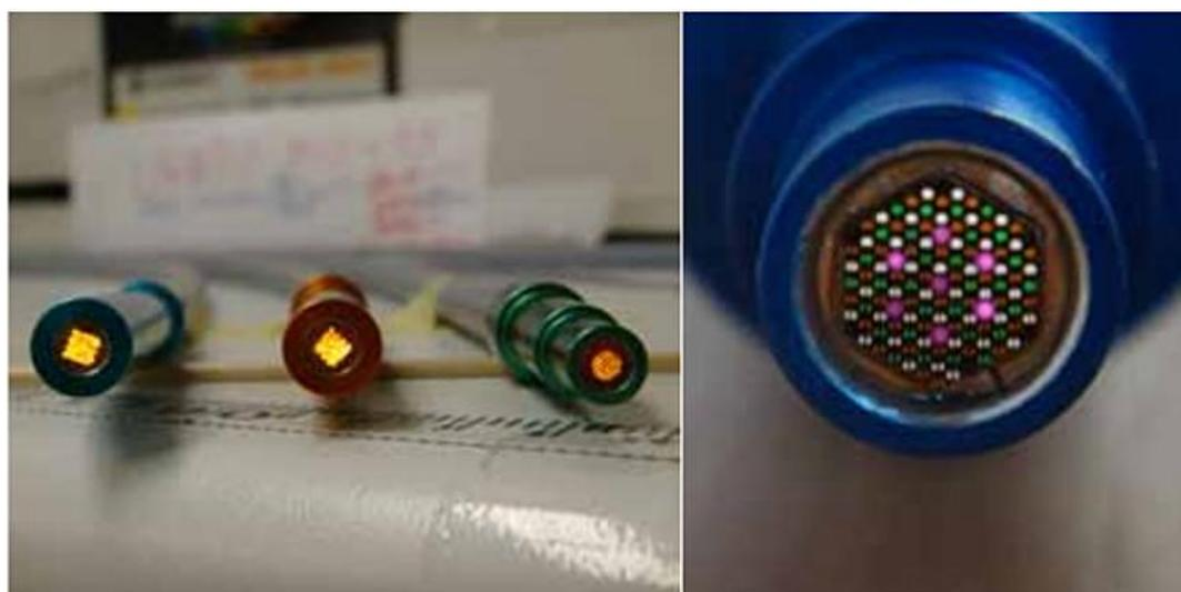
由紫外石英光纤、可见-近红外石英光纤和中红外光纤组成的混合光纤束，可实现 0.2 $\mu$ m 至 6 $\mu$ m 光谱范围内的远程光谱分析
