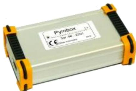
利用该接口, 可将热释电探测器直接连接至个人电脑 (PC)。此接口具备与 PEM710 诸多相同的功能特性, 但不配备显示屏或内置控制台控件。相反, 控制台与传感器可通过 USB 连接及配套软件实现完全控制。Pyrobox 会对所连接传感器输出的信号进行转换, 并将其传输至 PC。每个接口均采用针对特定探测器优化设计的模拟信号通路。
